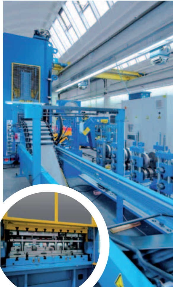
Urządzenie do perforacji wstępnej ze zintegrowaną prasą mechaniczną
