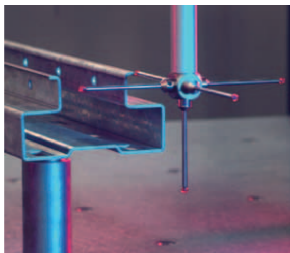
Kontrola wymaganych tolerancji profili
