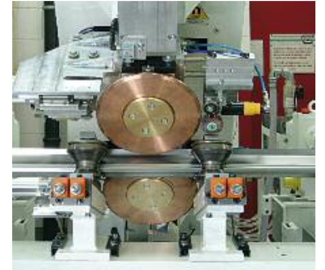
窓、ドア補強プロファイル材のローラーシーム溶接
