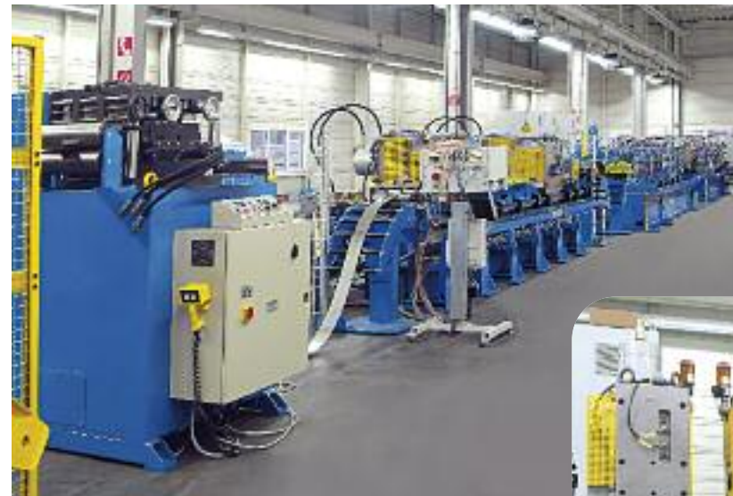
自動車座席移動レールの成形機
