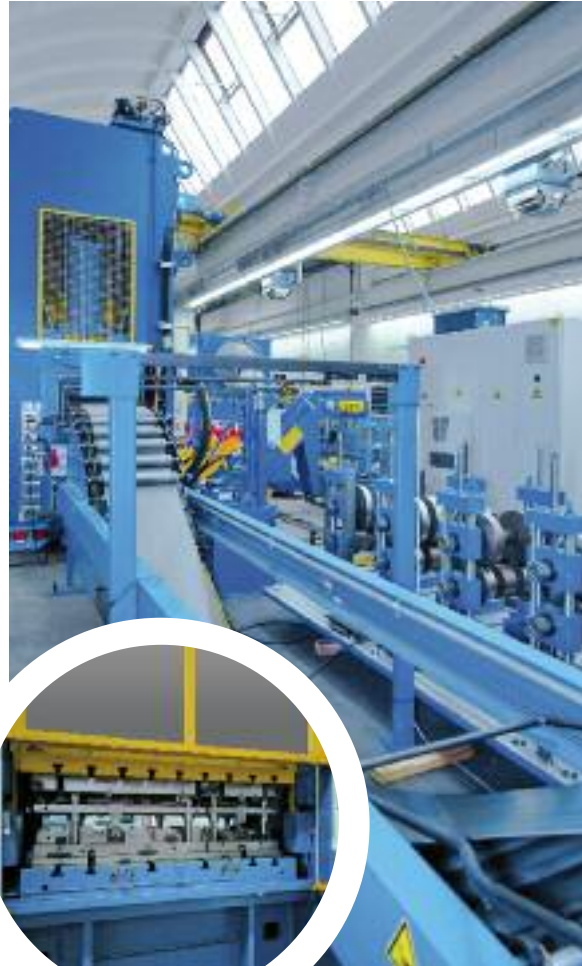
機械式プレスを備えた ブレ・パンチ装置
