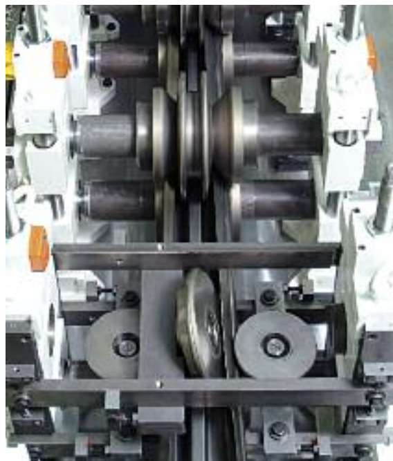
試験機でのロール成形工程
