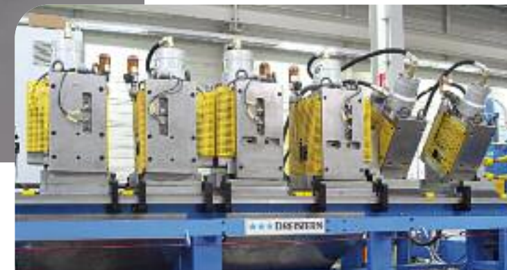
油圧式の間パンチング装置
