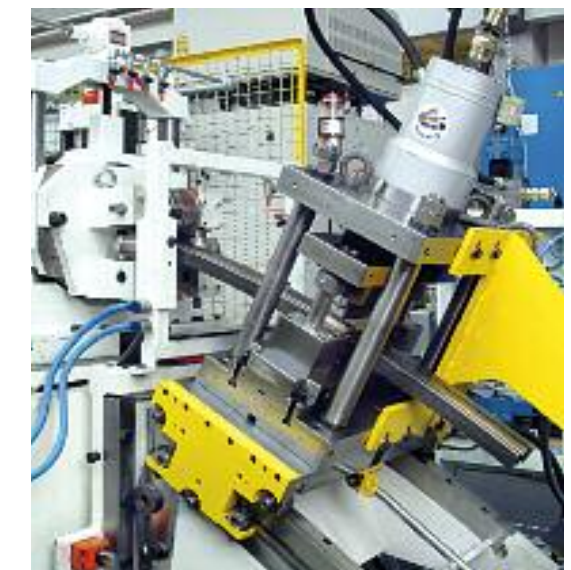
バンパープロファイルのポストバンドと切断
