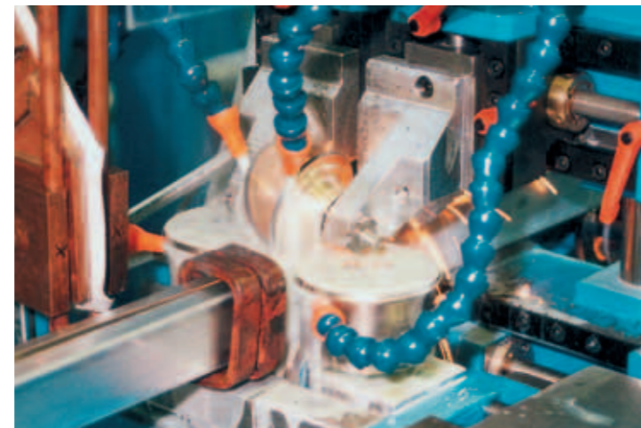
HF-Schweißen eines Formrohres
