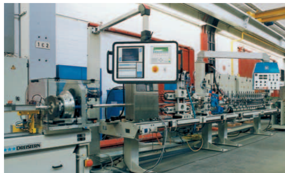
Ligne de soudage de tubes à paroi fine
