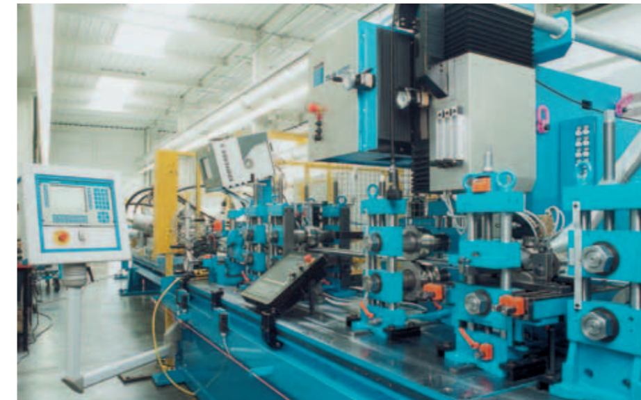
Ligne de soudage laser de renforts latéraux de portières d'automobiles
