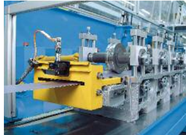
機械の材料投入側のエントリー・ガイド
