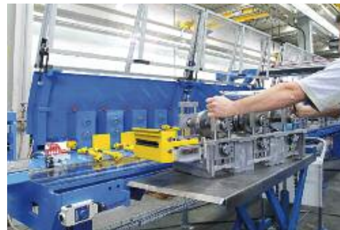
簡単に迅速な金型カセットの交換
