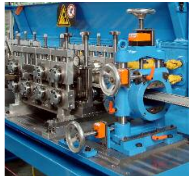
機械出口側の成形プロファイル直線器ユニット
