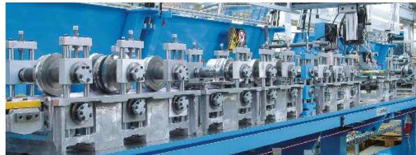
発泡材充填ローラーシャタースラット用製造ライン
